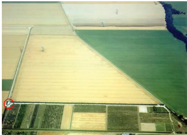
Abb. 3: GEO 600 bei Hannover aus der Luft. Deutlich zu erkennen: die beiden 600 m langen Arme für die Teilstrahlen des Interferometers. Der Rest des Interferometers mit Laser und Mess-Station befindet in dem Gebäude im roten Kreis.
